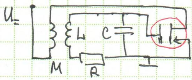
Возникновение заряда  $q$  на конденсаторе приведет к появлению напряжения на затворе  $U_{зп}$  а следовательно к увеличению тока  $I_{си}$  через транзистор и через индуктивность в цепи стока. Это в свою очередь вызовет появление ЭДС взаимной индукции в цепи контура. Если знак коэффициента  $M$  выбран правильно, то действие ЭДС взаимной индукции приведет к увеличению напряжения на конденсаторе. Т.о. возникает лавинообразное увеличение амплитуды колебаний в контуре.
